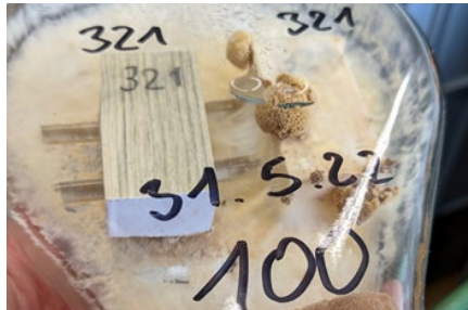
Balken-Blättling / Käferholz mit biozidhaltiger Öllasur unbewittert
